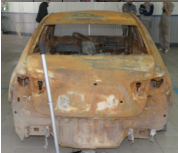
Фото 1-4. Внешний вид сгоревшей автомашины Hyundai Elantra
